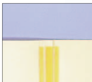
Lepidlo je naneseno ve třech pruzích, což zajišťuje dobrou pevnost vazby.
